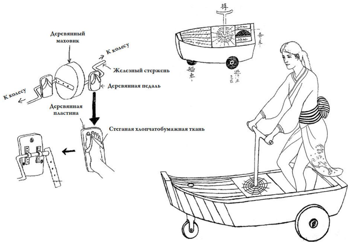
Рис. 1.2. «Рику-Хон-Сеся» («наземная лодка, движимая толчками») Хираиси и конструкция ее педального привода (© Shiga State Library, фото и реконструкция Кадзюсуке Конке; Kazusuke Koike)
