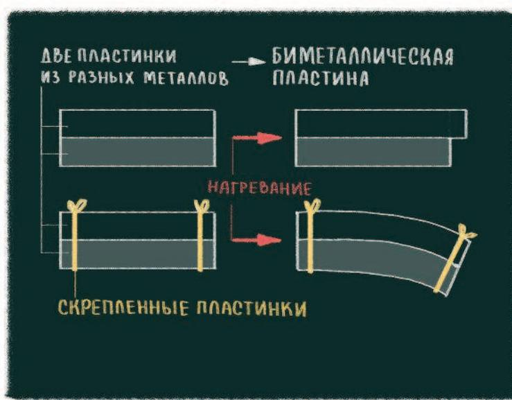
Если такую двойную пластину (она называется би-метал-ли-чес-кой) свернуть спиралью и закрепить одним концом, то при изменении температуры она будет поворачиваться, а если к ней прикрепить стрелку и шкалу – получится термометр!
